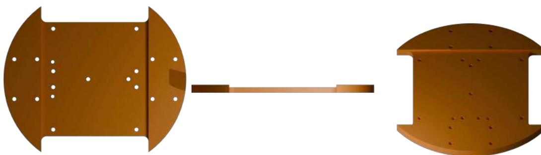
Figura 2.7: Vista superior, perfil e perspectiva da base com perfurações para fixação e encaixe de componentes.
