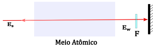
Figura 2.3: Esquema experimental da Espectroscopia de Absorção Saturada, mostrando o feixe forte ( E_s ) e o feixe fraco ( E_w ), que são colineares e contrapropagantes.
