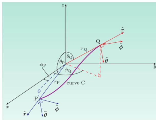
Figura 2.3: Vetores de base apontando em diferentes direções para cada ponto. Fonte: (Lambourne 2010).
