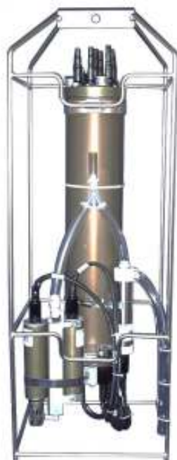
Figura 3.2: Aparelho de CTD Sea Bird Electronics SBE911plus usado na coleta de dados do projeto REVIZEE. Fonte: www.seabird.com/sbe911plus-ctd
