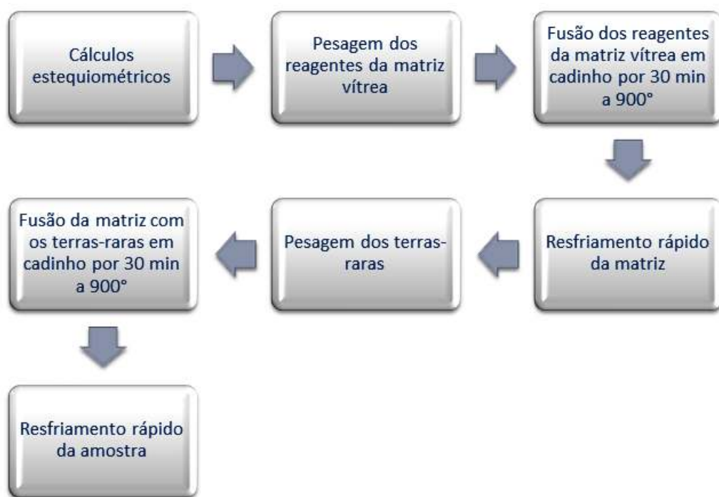
Figura 3.3: Fluxograma ilustrado as etapas de preparação das amostras.
