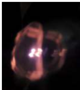
Figura 4.8: Imagem real de um fósforo vítreo 80\text{PbGeO}_3\text{-}10\text{PbF}_2\text{-}10\text{CdF}_2 co-dopado com \text{Eu}^{3+}\text{-Tb}^{3+} .
